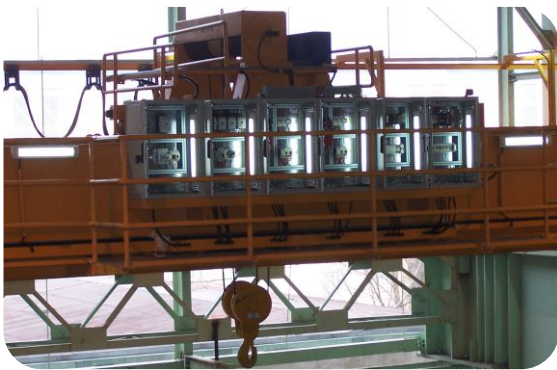
19) Double Speed Option on Travelling Motor Функция двойной скорости при перемещении моста
